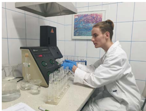
Рис. 1. Аналіз мінеральних добрив на вміст йонів Калію методом полум'яної фотометрії
