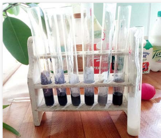
Рисунок 1. Зразки кисломолочної продукції до та після додавання йодистокалієвого крохмалю
